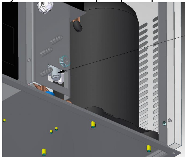
Рис 6. Расположение фильтра подачи воды на заполнение ванны
