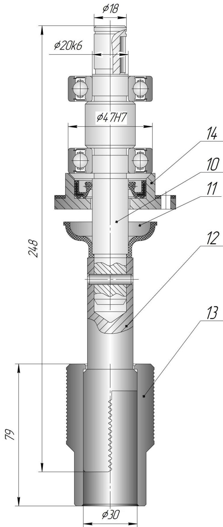
Рисунок – 5 Вал вертикальный в сборе
