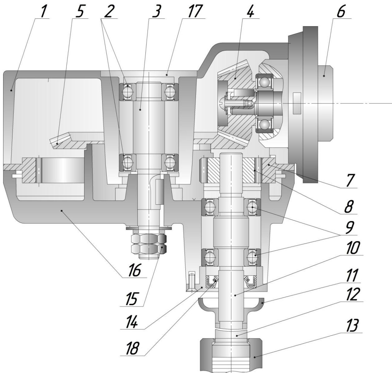
Рисунок – 4 Механизм для взбивания и перемешивания
