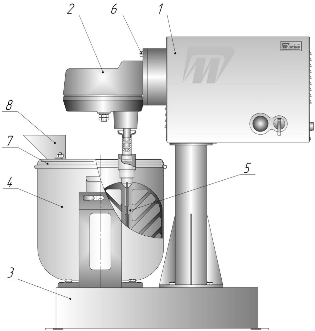
Рисунок – 1 Машина для взбивания и перемешивания УКМ – 14 (МВ-25)
