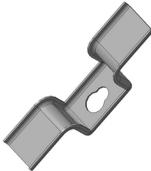
Рисунок 6 – Съемник к мясорубке ММП–II–1
